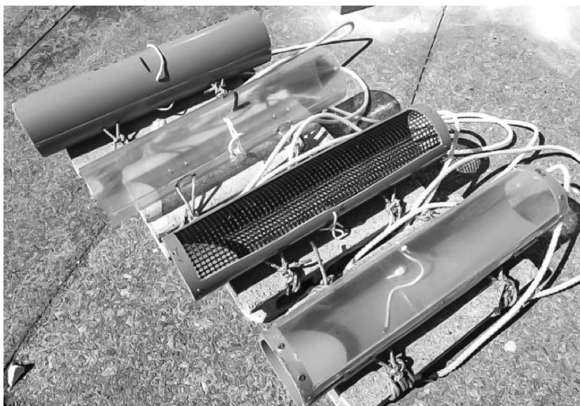
図1. 試験に用いた4タイプの放流器. 左上から右下に向かって順に①塩ビパイプ未加工型, ②透明パイプ型, ③塩ビパイプトリカルネット型, ④塩ビパイプ—透明フィルム型. 放流器の下には沈設用ブロックを取り付けている.
